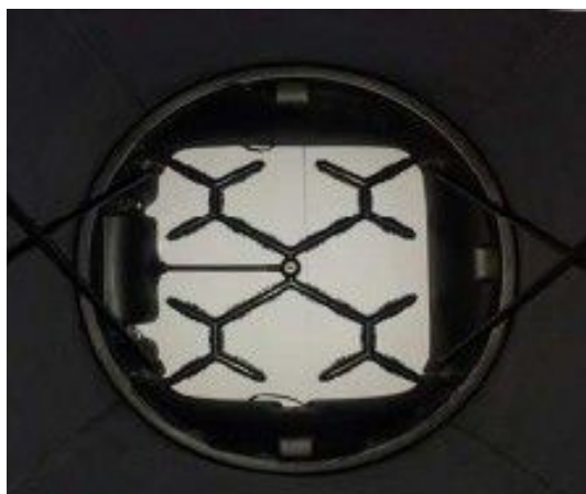
DUWEI 760 型高性能风罩的核心阵列式均风速传感器
