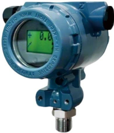
DW8082压力变送器用于测量液体或气体的现场压力，然后将其转变成 4~20mA DC 输出，叠加 HART 通讯协议。
